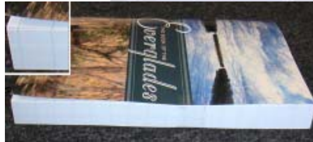
Simulation einer schlechten Registrierung – gezackte Linien an den Rändern der Buchseiten
