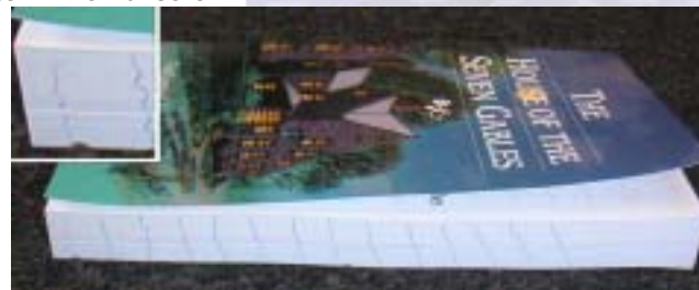
Simulation einer schlechten Registrierung – gezackte Linien an den Rändern der Buchseiten
